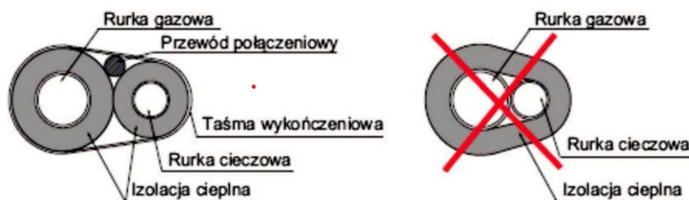
Rysunek 1 Sposób izolowania rurociągów
